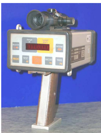
Obr. 11 – Laserová pistole RIEGL LR90-235/P
